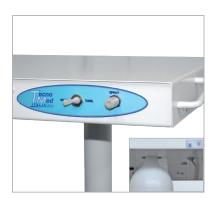
Nel pannello comandi frontale di Dentaway sono ubicati il regolatore acqua/spray e il selettore a leva dello strumento di destra o di sinistra. Nella parte inferiore è presente il selettore a leva di acqua/ spray.
